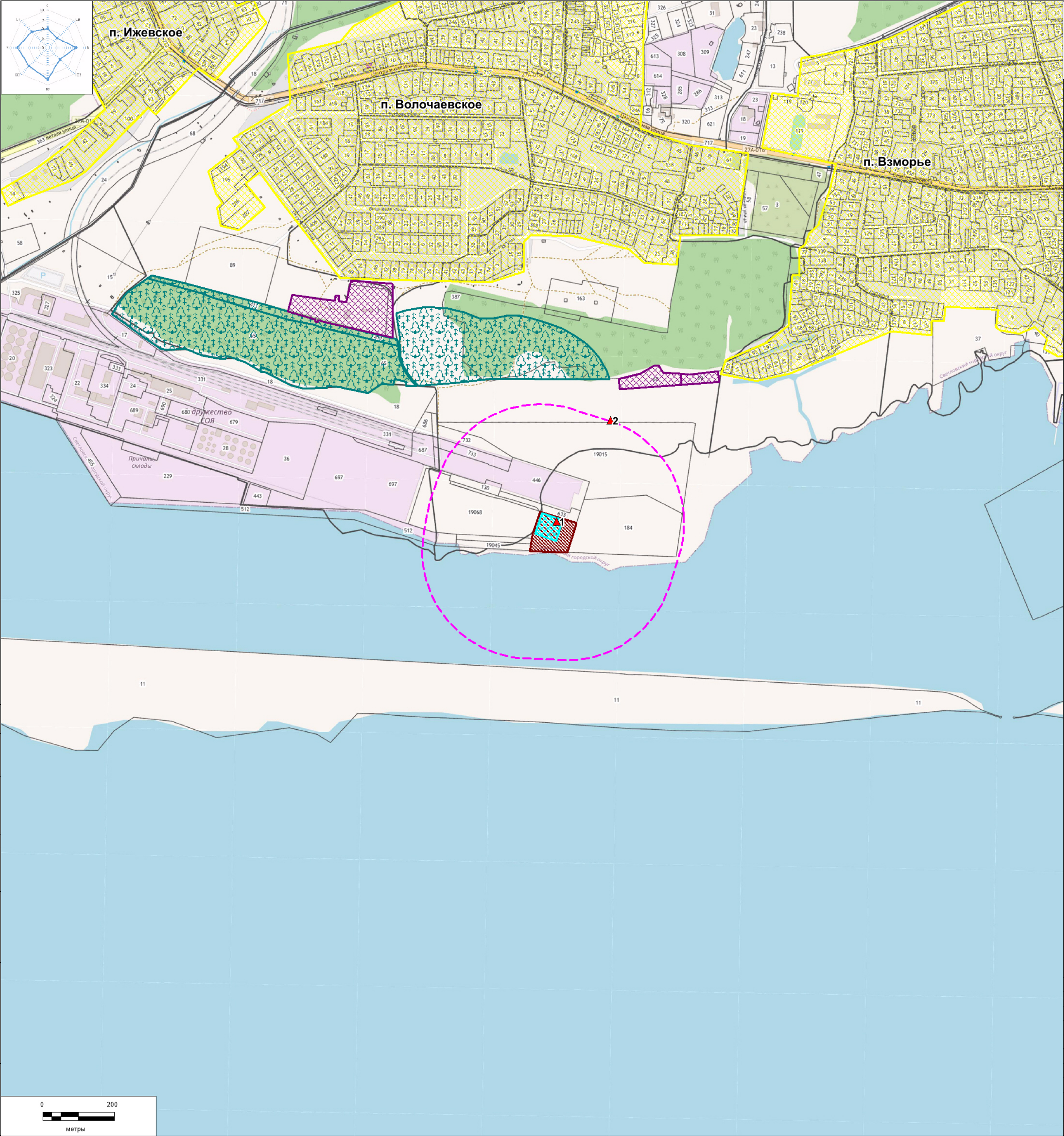
Ситуационная карта - схема расположения комплекса сооружений по утилизации отходов в г. Светлый Калининградской области с нанесением нормируемых территорий, санитарно-защитной зоны и точек отбора почвы на период строительства
