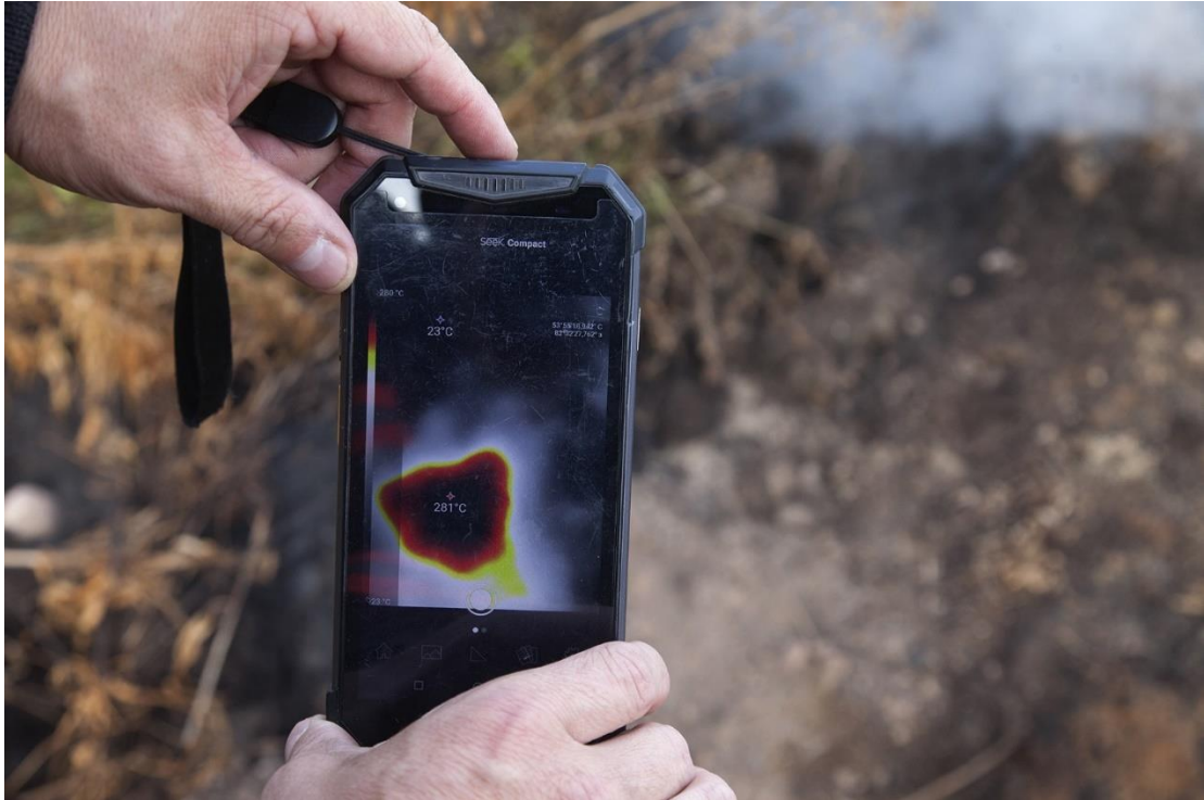
Рис. 4.1. Обследование уходящих в зиму очагов тепловизором Seek Thermal
