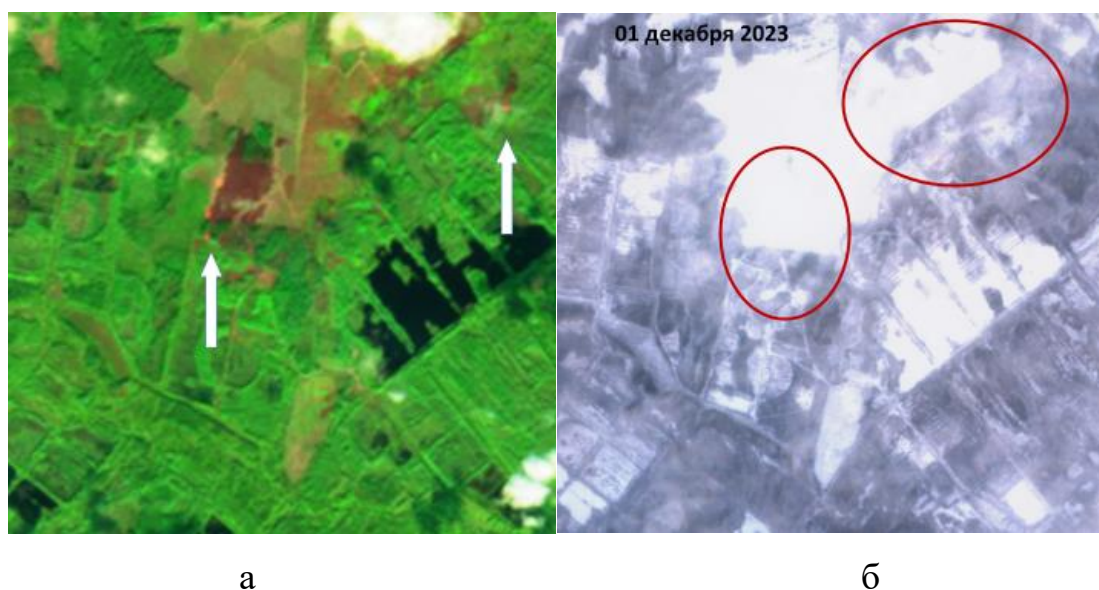
Рис. 4.10. Последние (осенние) возобновления активности кромки пожара (а) и зимние снимки этих же участков (б)
