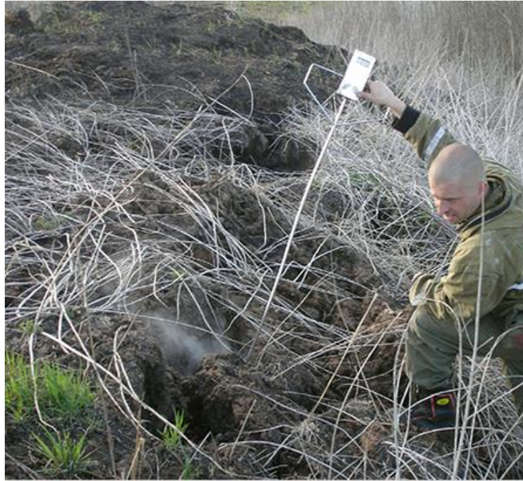
Рис. 4.3. Тление торфа, сохранившееся в бывшем штабеле (караване) добытого торфа после зимы
