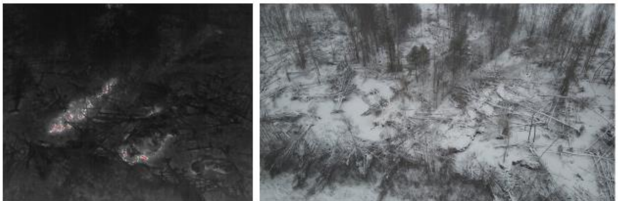
Рис. 4.12. Сравнение тепловизионного (а) и визуального (б) изображения очага тления
