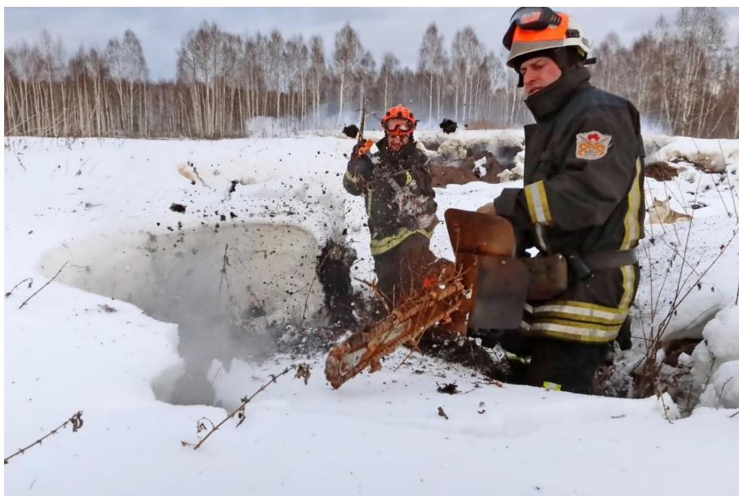
Рис. 4.14. Разрезание мерзлого грунта георипперами для исследования структуры очагов, обнаруженных по данным БВС
