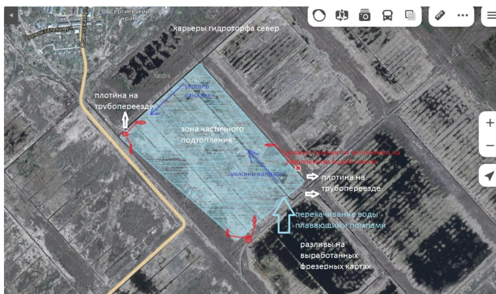
Рис. 4.23. Схема тушения с применением подтопления за счет перекачивания воды мотопомпами
