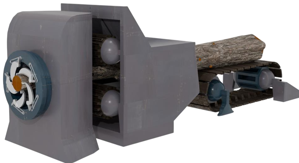
Рисунок 4.44 – Пример применения цифрового прототипа хлыста ели с окорочным станком
