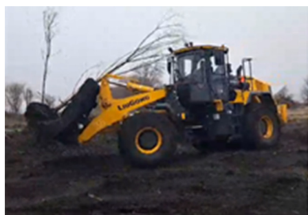
Рис. 4. Испытания опытного образца корчевального оборудования
