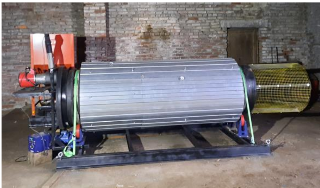
Рис. 3. Опытно-промышленный биореактор барабанного типа в сборе
