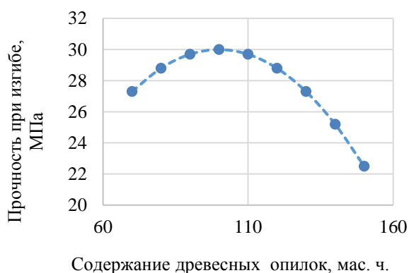
Рисунок 4.56 – Зависимость прочности при изгибе образцов ПКМ от содержания древесных опилок ( Z_1 )
