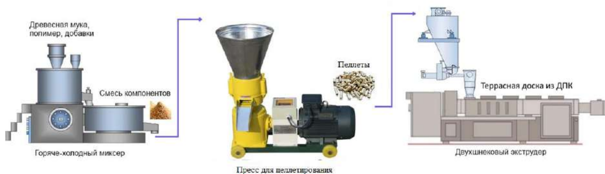
Рисунок 6.4 – Схема технологического процесса производства профильно-погонажных изделий из композитов с полимерной фазой синтетических и природных термопластов и лигноцеллюлозными наполнителями
