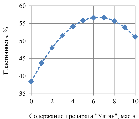
Рисунок 5.127 – Зависимость пластичности образцов ПКМ от содержания препарата «Ултан» (Z)
