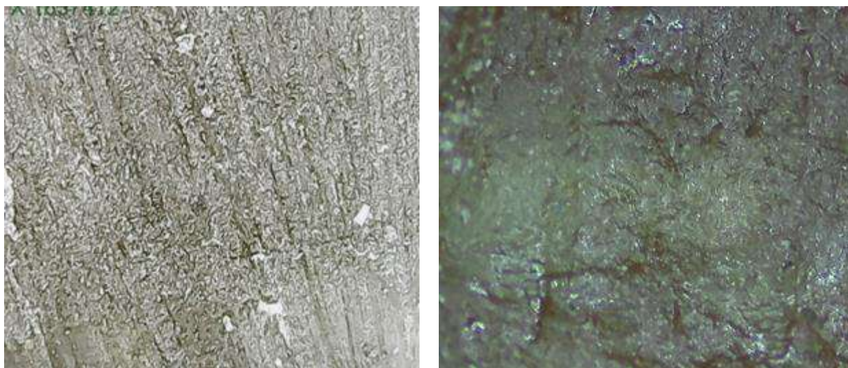
Рисунок 3.1 – Динамика биоразложения в активированном грунте ПАЦ (1) и образцов ПКМ с полимерной фазой пластифицированного ацетата целлюлозы и лигноцеллюлозными наполнителями (2–7)
