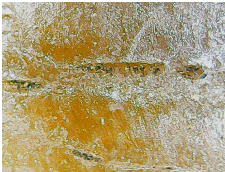
Рисунок 3.10 – Фотография поверхности образца пластифицированного ацетата целлюлозы (опыт № 1) после 140 суток выдержки в активированном грунте при увеличении 60х
