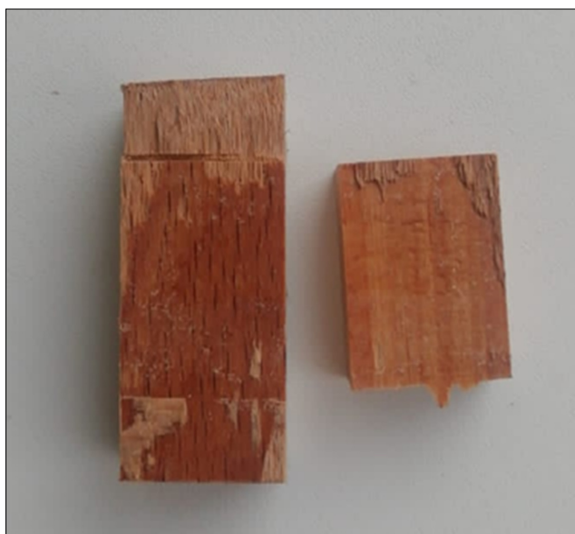
Рис. 7. Характер скалывания образца 2. К. О. Fig. 7. The nature of the cleavage of the sample 2. C. S.
