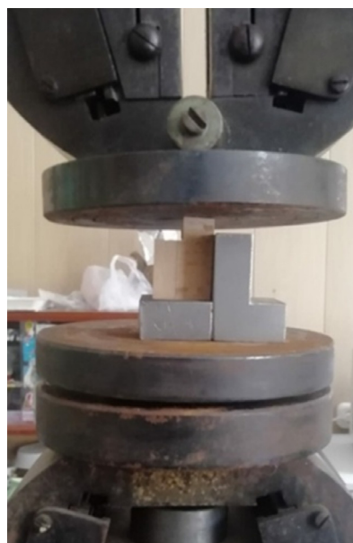
Рис. 4. Образец, закрепленный в специальном приспособлении, под нагрузкой испытательной машины Fig. 4. The sample is fixed in a special device under the load of the test machine
