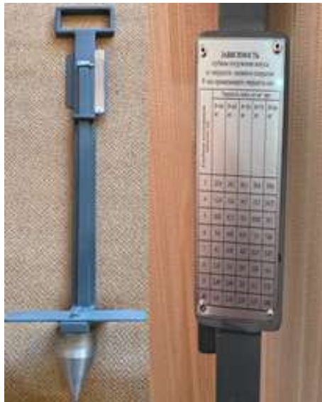
Рис. 1. Твердомер НИАС: 1 – конус; 2- площадка для ступни; 3 – вертикальная стойка; 4 – вертикальная доска-упор.
