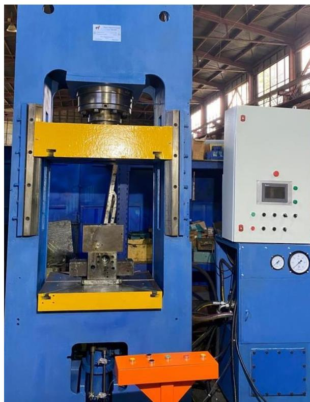
Рисунок 2.7 – Пресс гидравлический металлист ДЕ 2428-01
