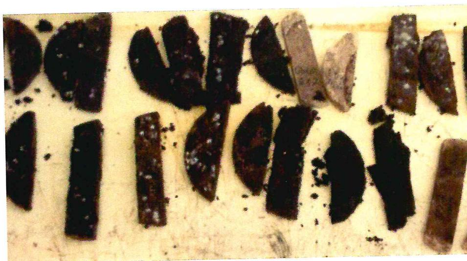
Рисунок 38 – Внешний вид образцов ПБС (на основе древесных опилок, шелухи пшеницы и проса) после 21 суток экспозиции в активном грунте
