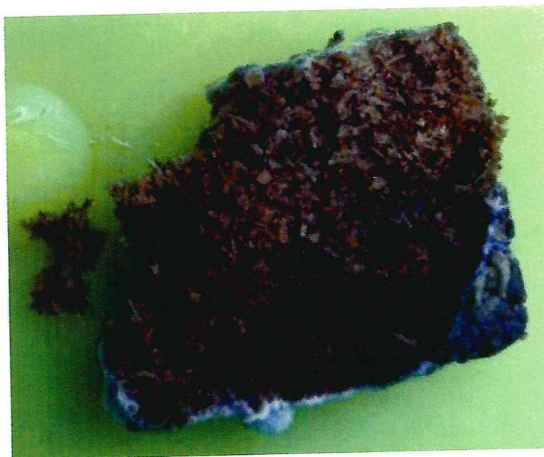
Рисунок 39 – Фрагмент ПДС (на основе древесных опилок) с признаками расслоения, разбухания, краевой и продольной фрагментации
