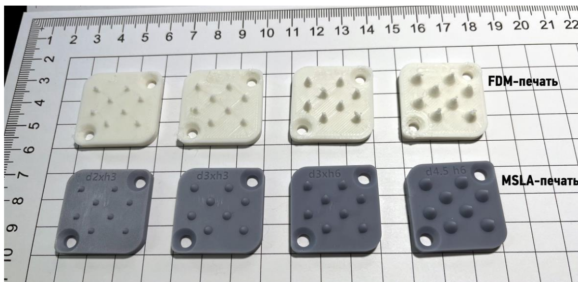
Рисунок 3.7 – Ошипованные контактные элементы, изготовленные методами аддитивных технологий
