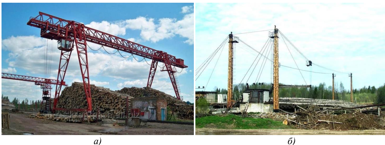
Рисунок 1.3 – Грузоподъемные краны, применяемые на нижних складах: а – козловой кран; б – кабельный кран.
