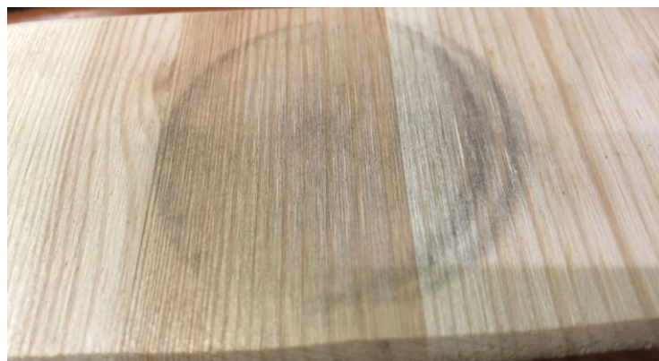
Рисунок 1.28 – Отпечаток на контактной поверхности после взаимодействия обрешиненного контактного элемента с образцом из древесины сосны
