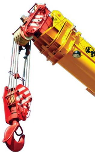
Рисунок 1.12 – Крюковая подвеска и полиспаст автомобильного крана
