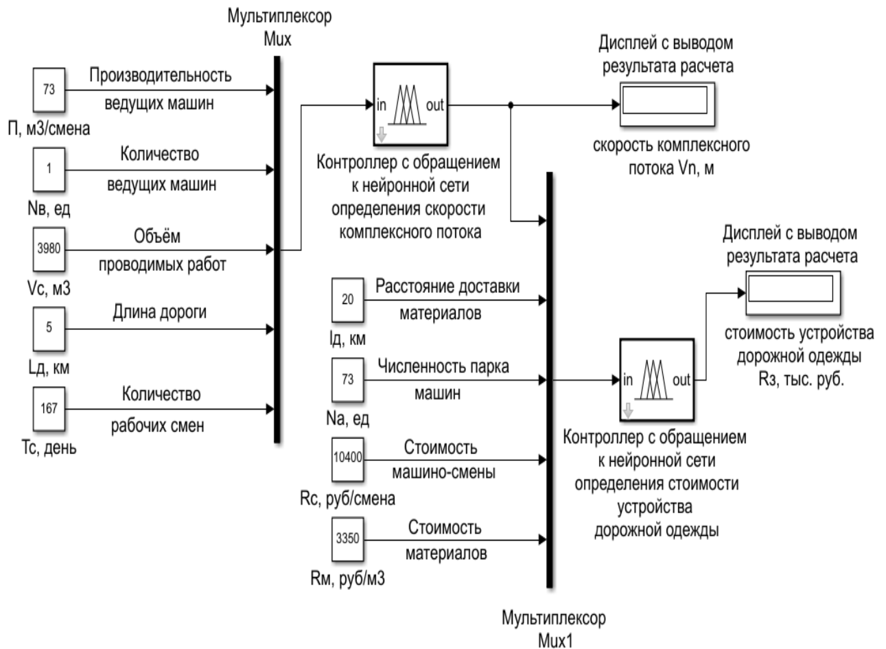
Рисунок 3.13 – Реализация интеллектуальной системы в среде визуально-блочного моделирования Simulink
