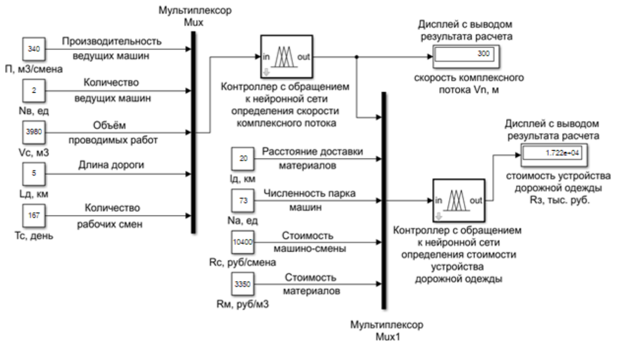
Рисунок 4.4 – Расчет функции P_3 = f(V_n f(\Pi, N_b, V_c, L_d, T_c), l_d, N_a, P_c, P_m)
