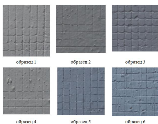
Рисунок 17 - Результаты исследований адгезионной прочности РЗ ЛКП древесной подложке
