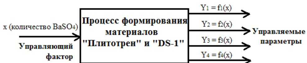
Рисунок 25 – Схема проведения эксперимента по определению влияния количества наполнителя на физико-механические свойства материалов:  $y_1$  - ударная вязкость,  $y_2$  - твердость по Бринеллю,  $y_3$  - разбухание по толщине,  $y_4$  - предел прочности при статическом изгибе
