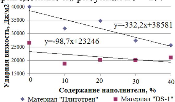
Рисунок 26 – Зависимость ударной вязкости материалов от содержания наполнителя
