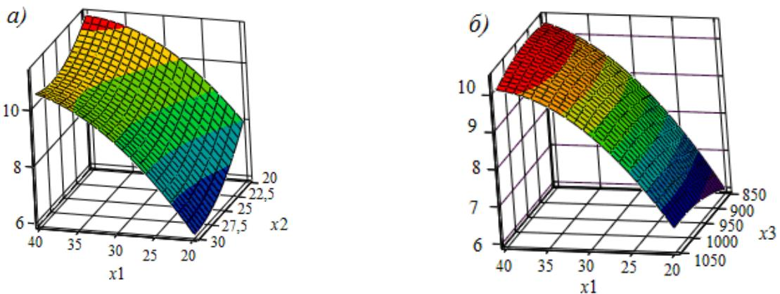
Рисунок 31 – Графическая интерпретация (выходной параметр – разбухание по толщине материала «Плитотрен»):  $x_1$  – содержание наполнителя;  $x_2$  – содержание клея;  $x_3$  – плотность материала
