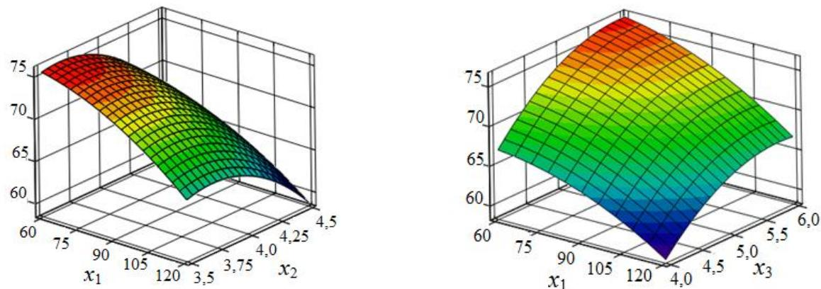
Рисунок 15 – Графическая интерпретация (выходной параметр – предел прочности при статическом изгибе):  $x_1$  – шероховатость поверхности шпона;  $x_2$  – толщина материала;  $x_3$  – время прессования
