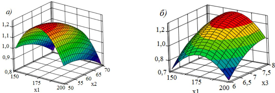
Рисунок 21 – Графическая интерпретация (выходной параметр – предел прочности при скальвании):  $x_1$  – расход клея;  $x_2$  – температура плит пресса;
