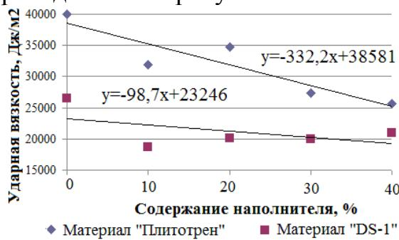
Рисунок 26 – Зависимость ударной вязкости материалов от содержания наполнителя
