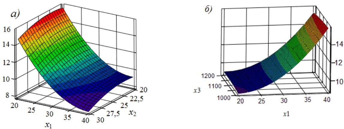
Рисунок 33 – Графическая интерпретация (выходной параметр – разбухание по толщине материала «DS-1»):  $x_1$  – содержание наполнителя;  $x_2$  – содержание клея;  $x_3$  – плотность материала
