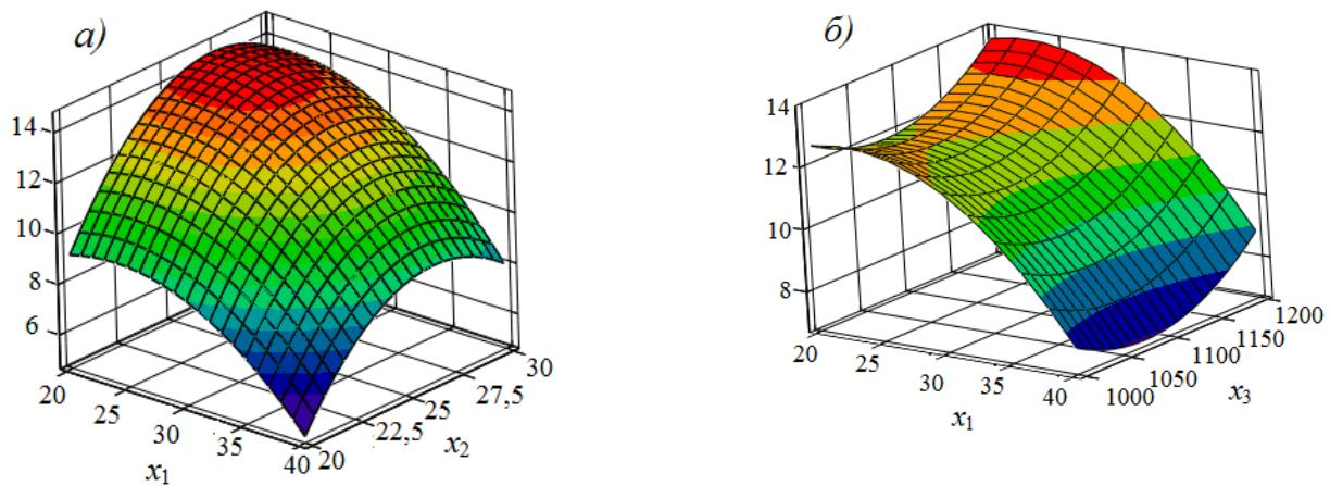
Рисунок 34 – Графическая интерпретация (выходной параметр – предел прочности при статическом изгибе материала «DS-1»):  $x_1$  – содержание наполнителя;  $x_2$  – содержание клея;  $x_3$  – плотность материала
