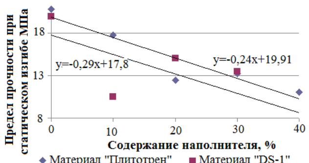
Рисунок 29 – Зависимость предела прочности при статическом изгибе материалов от содержания наполнителя
