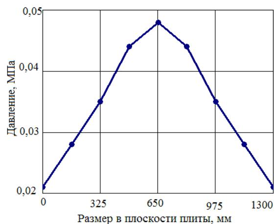
Рисунок 7 – Распределение давления в плоскости плиты
