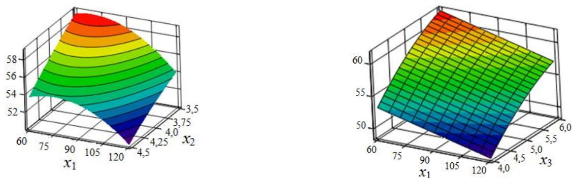
Рисунок 16 – Графическая интерпретация (выходной параметр – предел прочности при растяжении):  $x_1$  – шероховатость поверхности шпона;  $x_2$  – толщина материала;  $x_3$  – время прессования
