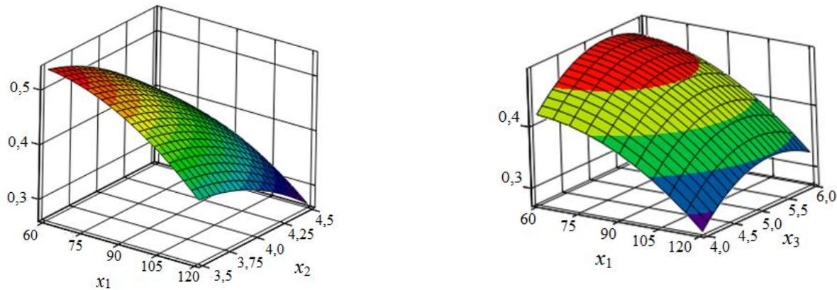
Рисунок 14 – Графическая интерпретация (выходной параметр – предел прочности при скальвании):  $x_1$  – шероховатость поверхности шпона;  $x_2$  – толщина материала;  $x_3$  – продолжительность прессования
