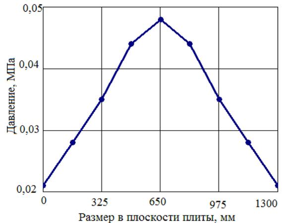
Рисунок 7 – Распределение давления в плоскости плиты
