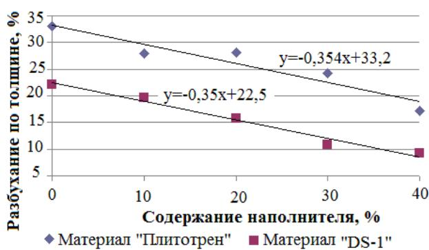
Рисунок 28 – Зависимость разбухания по толщине материалов от содержания наполнителя
