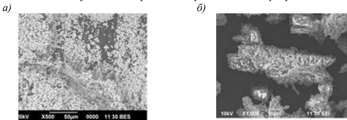
Рисунок 36 – Микросъемка древесно-клейевой композиции материала:
