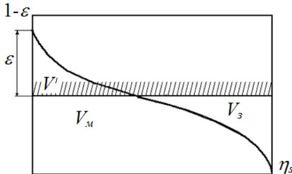
Рисунок 1 - Схема расчета плотности стыка при контакте:  $V_M$  - объем материала, рассчитанный на единицу контурной площади контакта;  $V_3$  - объем зазора;  $V'$  - уменьшение объема материала за счет деформации выступов
