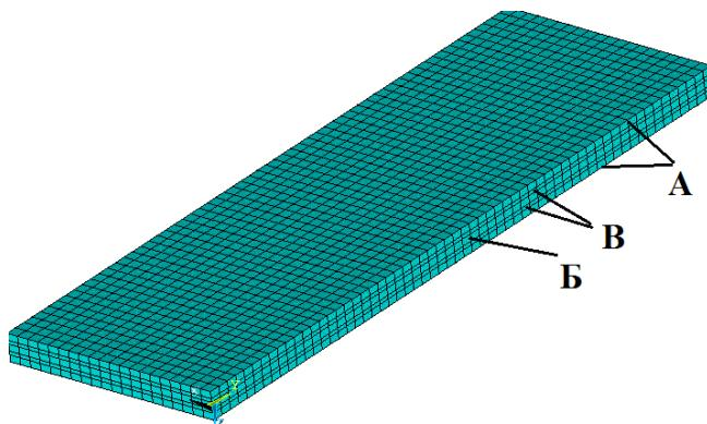
Рисунок 8 – Оболочечная конечно-элементная модель материала
