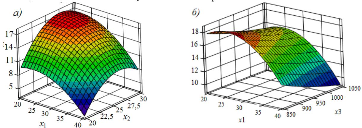
Рисунок 32 – Графическая интерпретация (выходной параметр – предел прочности при статическом изгибе материала «Плитотрен»):  $x_1$  – содержание наполнителя;  $x_2$  – содержание клея;  $x_3$  – плотность материала
