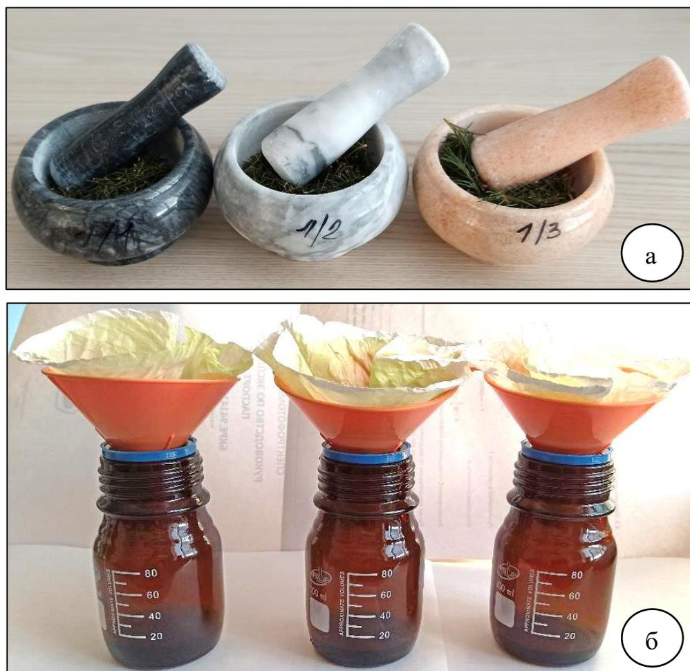
Рисунок 2.9 – Подготовка образцов спиртовой вытяжки из хвои к спектрофотометрическому исследованию (а – измельчение навески хвои; б – фильтрация экстракции)
