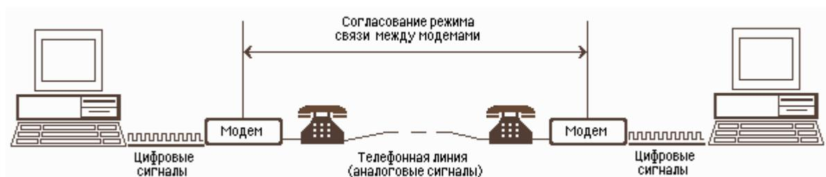
Рис. 2.24. Схема реализации модемной связи
