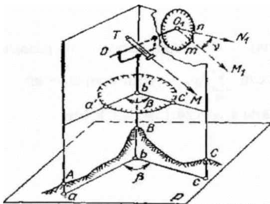
Рис. VI.1. Принцип измерения горизонтальных и вертикальных углов.
