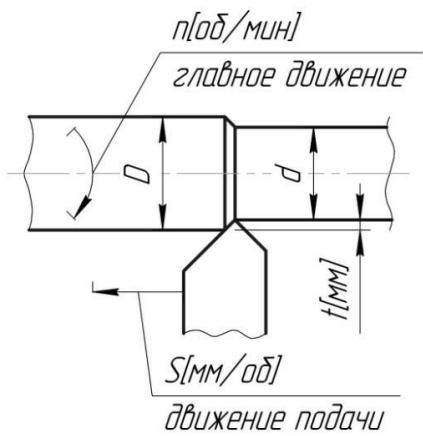
Рис. 1 – Эскиз элементов режима резания при обтачивании
